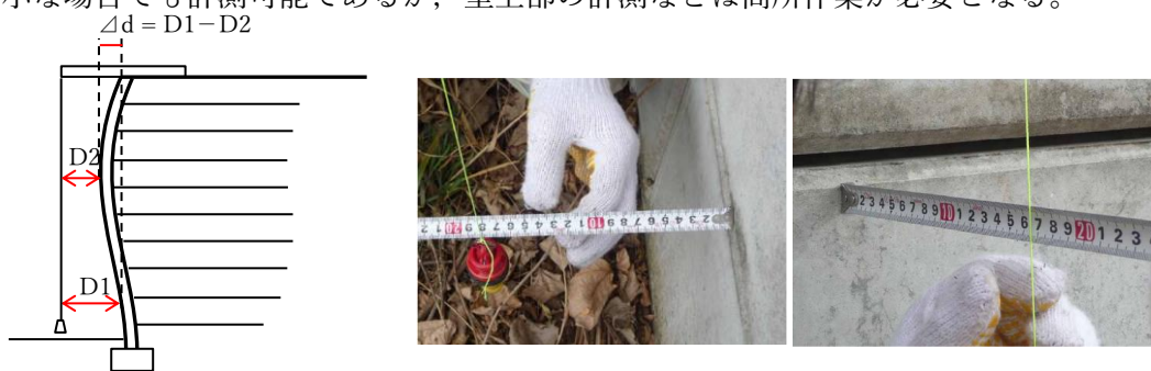
図-4 下げふりによる測量
