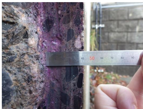
図-6 フェノールフタレイン法による中性化調査
