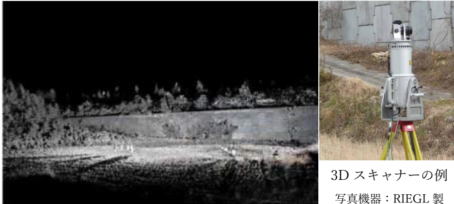
図-5 3D レーザースキャンによる測量
