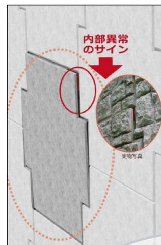
FS コネクティブを採用することで、鋼材の引張強度を超えるような過剰な応力が生じた場合に、まずコネクティブ A が機能喪失する。
