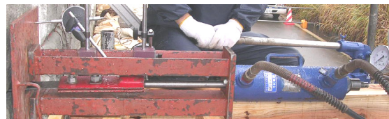
写真-3 ストリップ引抜き試験
