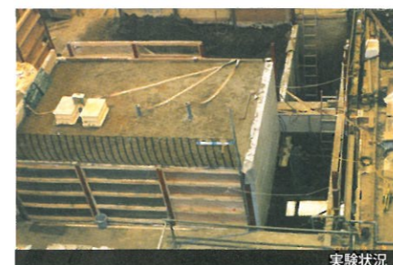
実際の壁面材を用いた水位急低下による性能確認実験
