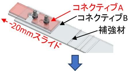
コネクティブBの長孔により、壁面は20mm傾斜し土圧などの荷重をコネクティブBが引継ぎます。
