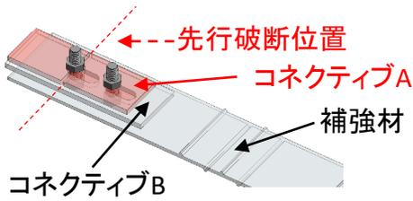
各コネクティブの破断強度を調整することで、盛土内部の異常時にコネクティブAが先行破断します。
