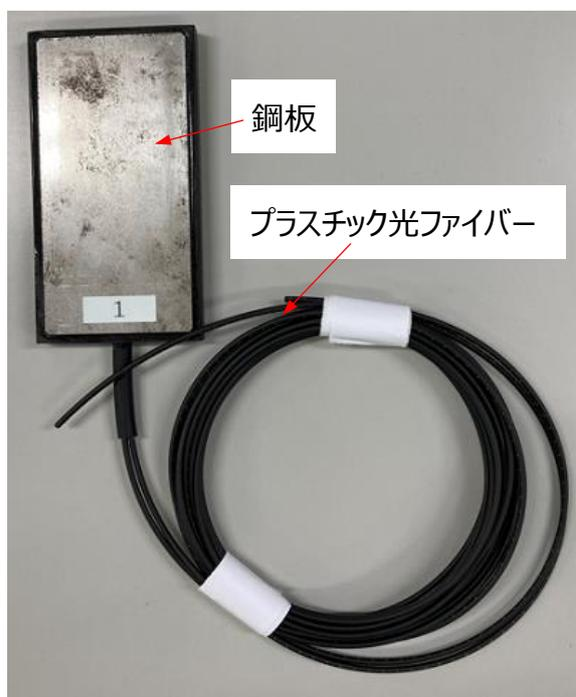
腐食検知の仕組み
